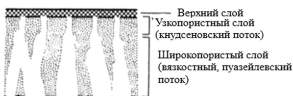
Рис. 1. Морфология и механизм транспорта в различных слоях асимметричной мембраны.
