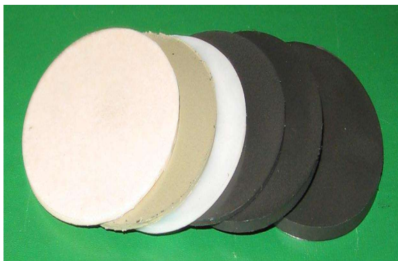
Рис.1. Фото экспериментальных образцов защитных композитных материалов на основе поливинилацетатного клея.
