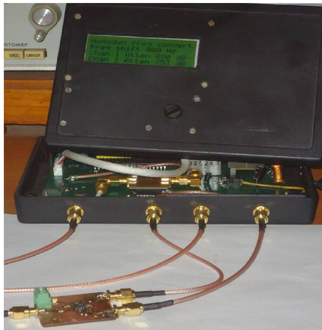
Рис. 9. Внешний вид микроволнового смесителя, подключенного к блоку формирования рабочих сигналов (со снятой крышкой).
