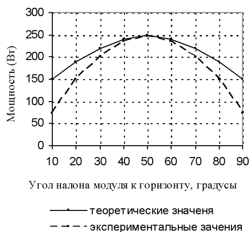
Рис. 6. Зависимость изменения выходной мощности фотоэлектрического модуля при изменении угла наклона (при освещенности около 950 Вт/м 2 ).
