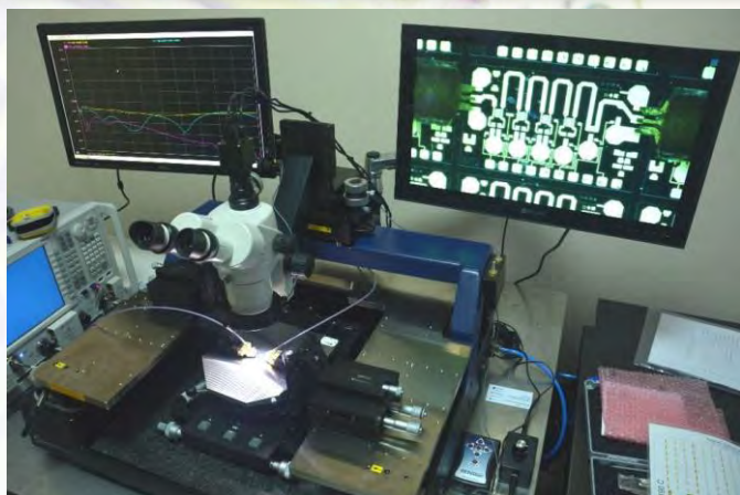
Стенд для тестирования кристаллов интегральных схем на базе зондовой станции Cascade EPS200RF
