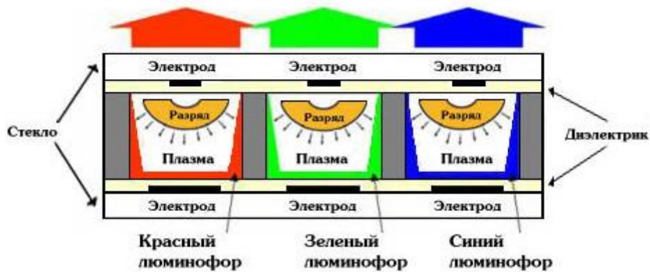
Рисунок 2.5 — Схема плазменной ячейки (пикселя)
