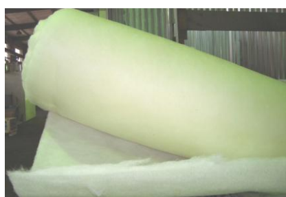
Рис. 2.14. Фильтрующий материал ФРНК–ППГ в рулоне
