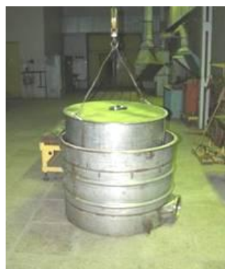
Рис. 2.28. Адсорбер угольный АУ–1500 ВМ: 1 – адсорбент, 2 – входной патрубок; 3 – верхняя решетка; 4 – корпус; 5 – выходной патрубок; 6 – нижняя решетка
