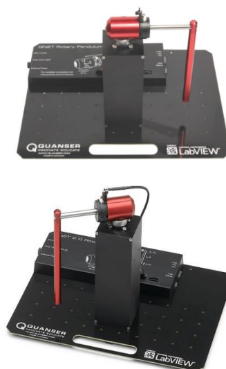
Лабораторный стенд с маятником Фуруты Quanser QNET Rotary Inverted Pendulum 2.0
