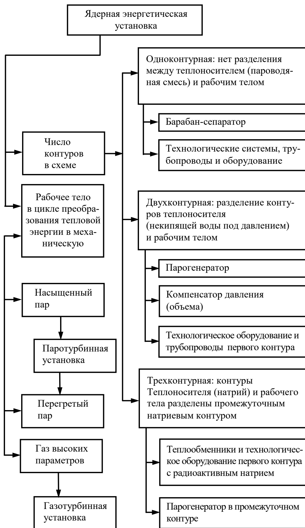
Рис. 2.2. Конструктивные особенности, физические и технологические характеристики ядерных энергетических установок
