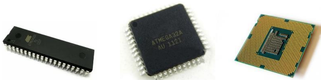
Рисунок 1.1 – Корпусы микропроцессоров Atmega32 и Intel Core i3
