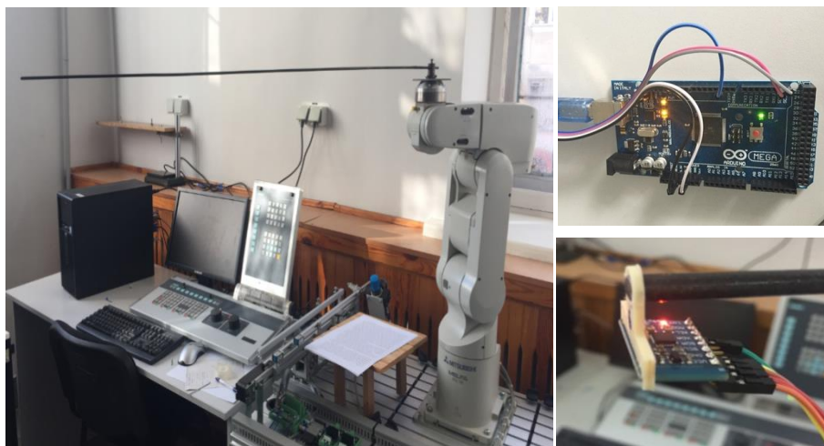
Рис.6 – Экспериментальный стенд для исследования оптимального вращения стержня конечной жесткости
