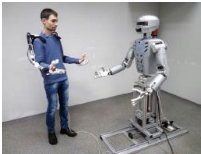
Рис.1 – Копирующий костюм и робот SAR-400
