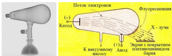
Рис. 9. Общий вид катодной трубки Рентгена в первых его экспериментах и эксперимент, объясняющий открытие X-лучей (1895 г.) [11]
