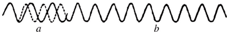
Рис. 13. Измеренные осциллограммы временной зависимости (а) переменного тока электростанции Страсбург, (b) колебания камертона [19].
