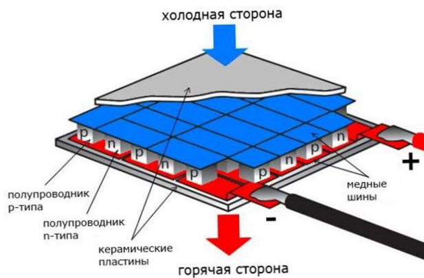
Рис. 4. Схема модуля Пельтье
