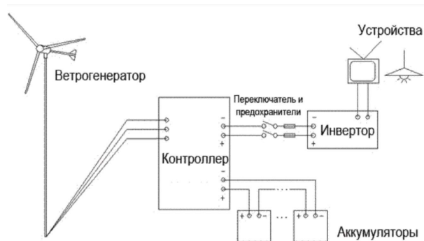
Рис. 13. Включение контроллера заряда аккумуляторов в структурную схему ветряной электрической станции.
