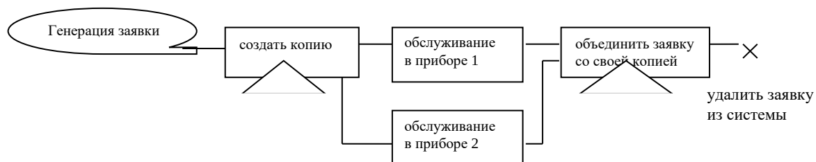
Рисунок 12 – Схема функционирования модели системы с параллельной обработкой заявки двумя приборами
