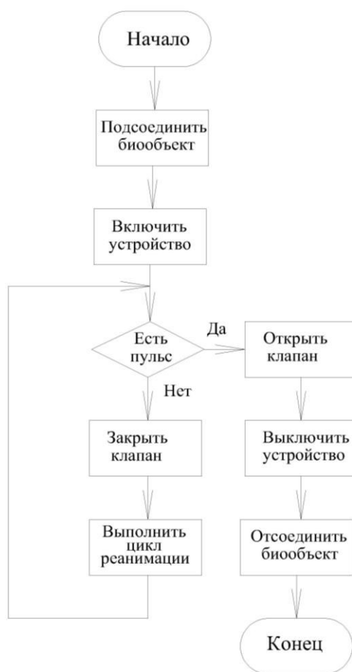
Рис.3 – Алгоритм работы переносного автоматизированного устройства для сердечно-легочной реанимации
