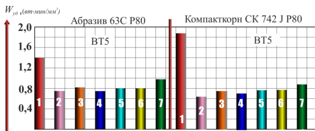
Рис. 8. Изменение удельной мощности при шлифовании в 0,5 м растворах солей: 1– H 2 O; 2– KF; 3 – NaF; 4–KNO 2 ; 5 – NaNO 2 ; 6 – KNO 3 ; 7– NaNO 3
