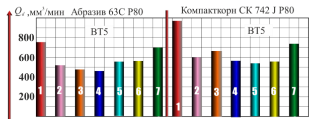
Рис 7. Износ абразивной ленты при шлифовании в 0,5 м растворах солей: 1– H 2 O; 2– KF; 3 – NaF; 4–KNO 2 ; 5 – NaNO 2 ; 6 – KNO 3 ; 7– NaNO 3
