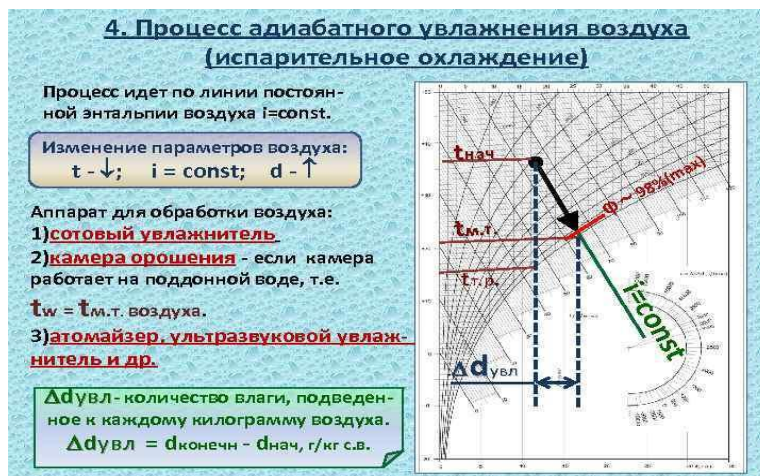
Рис. 2. Процесс адиабатного увлажнения воздуха на i - d -диаграмме
