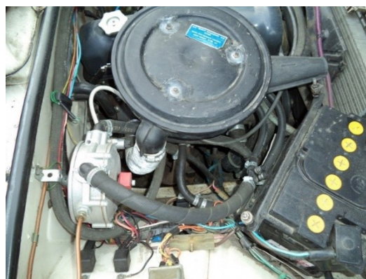
Рис. 1. ГБО 1-поколения на ВАЗ 2106
