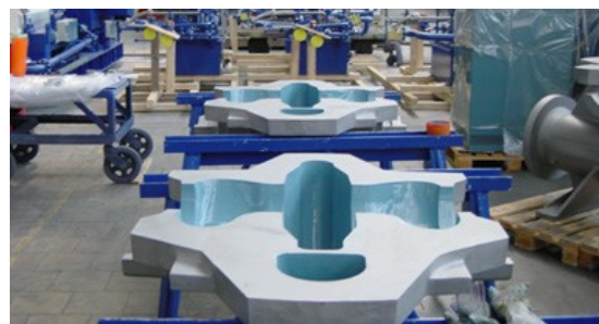
Рис. 6. Корпус насоса с покрытием Belzona 1341
