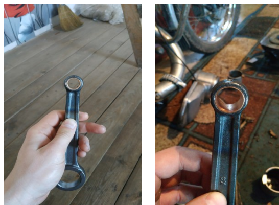
Рис.5. Шатун до (слева) и после (справа) разворачивания.
