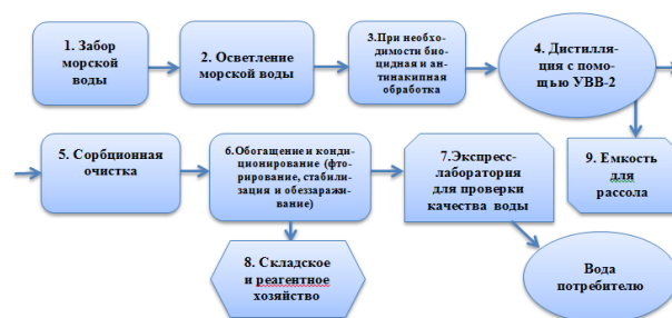
Рис. 2. Технологическая схема станции приготовления питьевой воды из вод Чёрного моря
