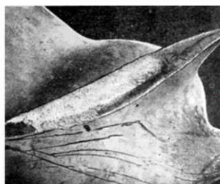
Рис. 2. Усталостное разрушение лопасти гребного винта крупнотоннажного танкера
