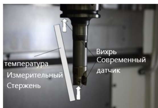
Рис.3. Измерение тепловых погрешностей станка и инструмента.
