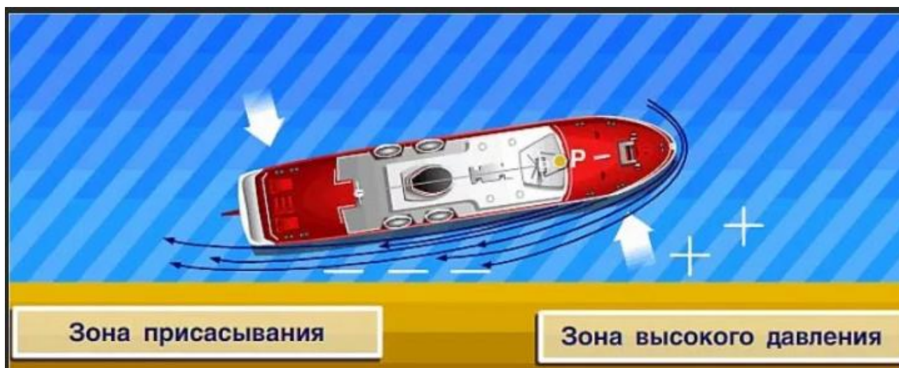
Рисунок 11.3 – Плавание вдоль кромки канала
