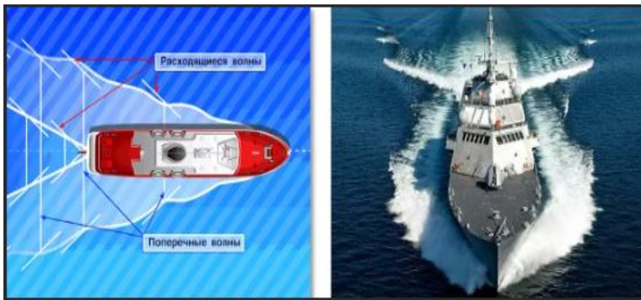
Рисунок 11.2 – Образование волн при движении судна
