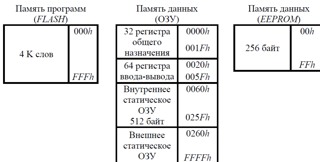
Рис. 1.2 — Структура памяти микроконтроллера ATMega8515
