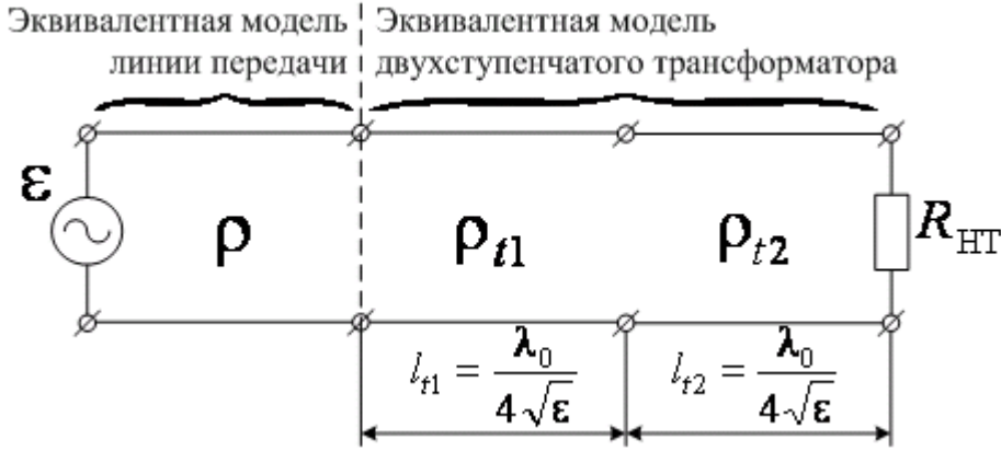
Рисунок 3.4 — Эквивалентная схема двухступенчатого четвертьволнового трансформатора
