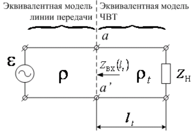
Рисунок 3.2 — Эквивалентная схема четвертьволнового трансформатора
