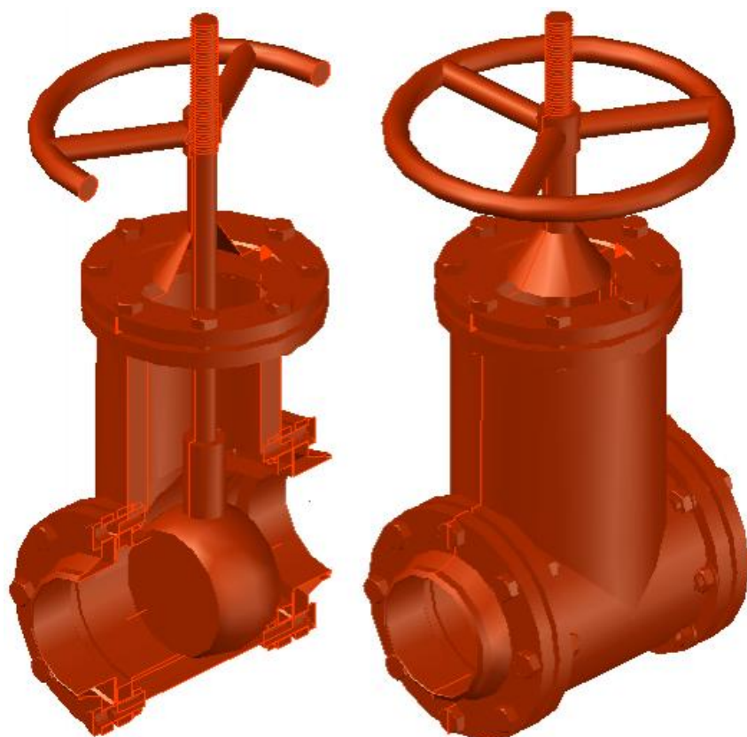
Рис. 14. Трехмерная модель клинкетной задвижки
