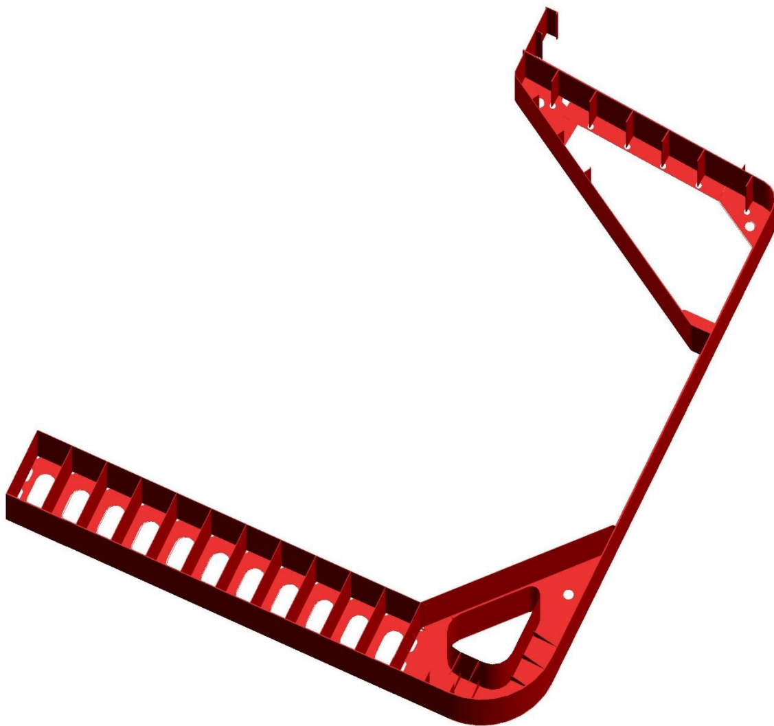
Рис. 9. Трехмерный мидель-шпангоут навалочного судна
