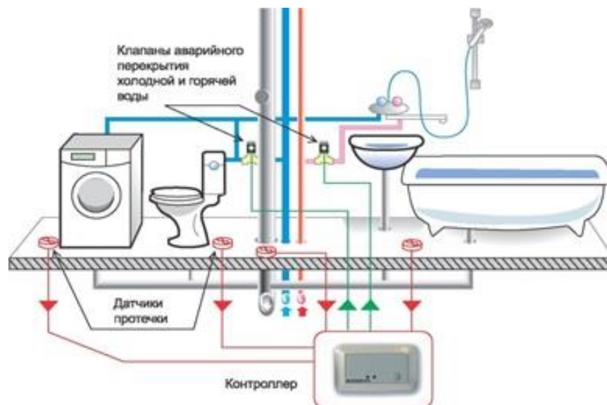
Рис.3. Схема защиты от аварийных ситуаций (утечек воды)
