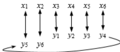
Рисунок 1.1. Соответствие между переменными взаимодвойственных ЗЛП.
