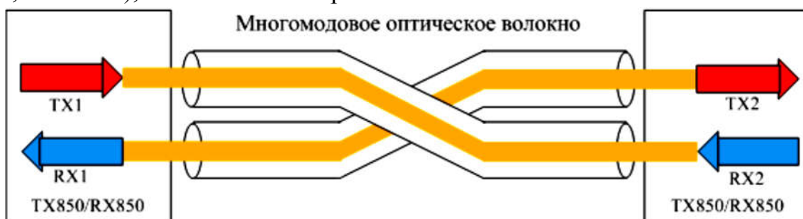
Рис. 1.4 — Принцип действия многомодового SFP -модуля
