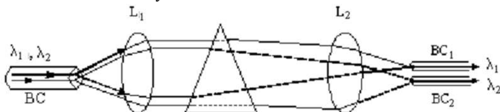
Рис. 2.3 — Схема разделения оптических несущих с помощью призмы
