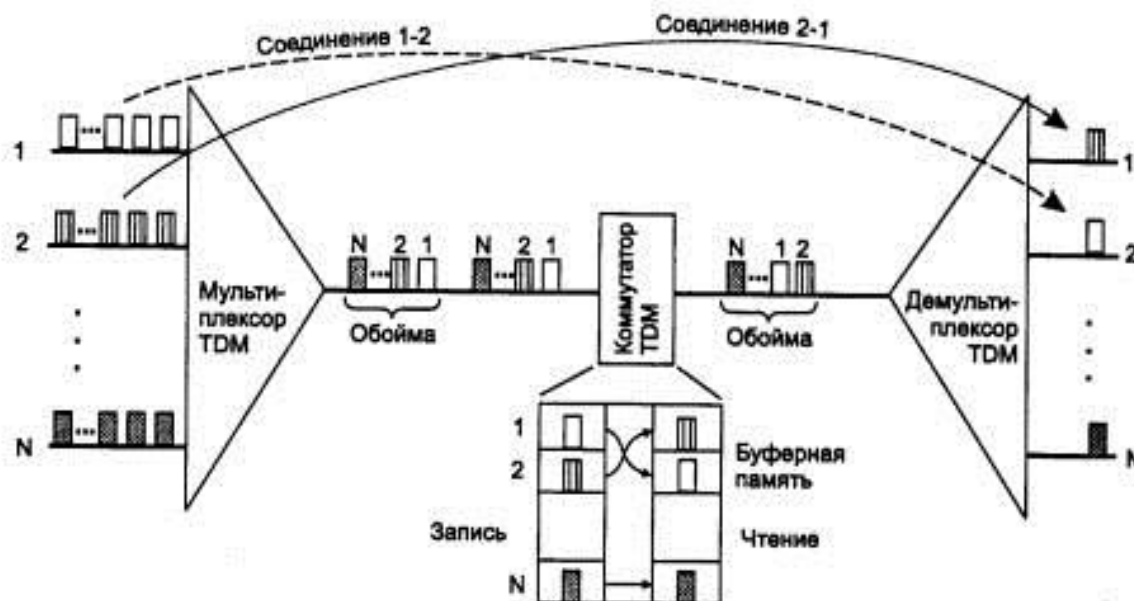
Рис. 3.16 — Коммутация на основе разделения канала во времени
