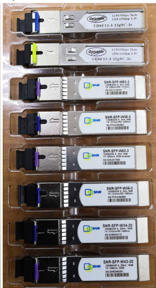
Рис. 1.6 — SFP -модули двухволоконные (а) и одноволоконные (б)
