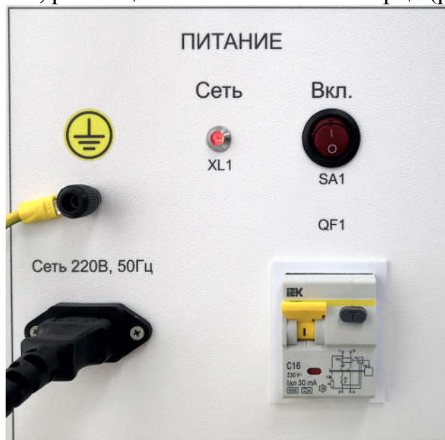
Рис. 1.2 — Панель блока питания лабораторного комплекса
