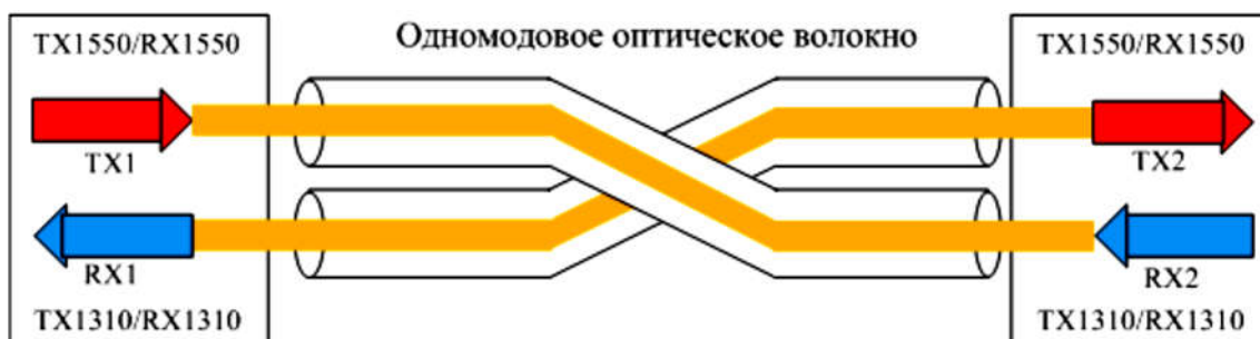
Рис. 1.5 — Принцип действия одномодового SFP модуля
