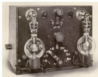
Рис. 11. Принципиальная схема двухкаскадного усилителя звуковой частоты на аудионах де Фореста и его общий вид в виде законченной конструкции. 1914 г.
