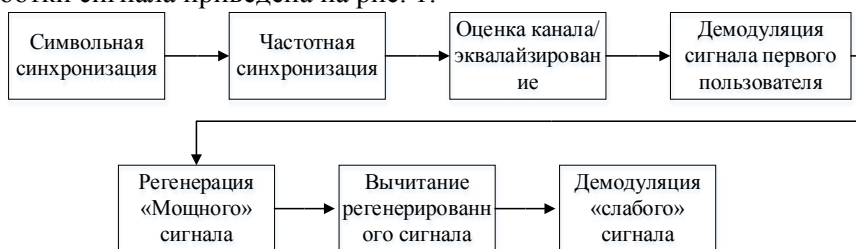
Рис. 1. Функциональная схема обработки сигнала PD-NOMA
