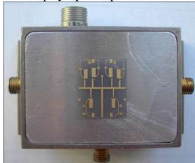
Рисунок 3. Корпус и топология ГИС двухканального переключателя X-диапазона.
