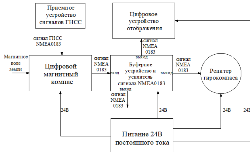
Рис.1. Структурная схема системы цифрового магнитного компаса с системой приема сигналов ГНСС
