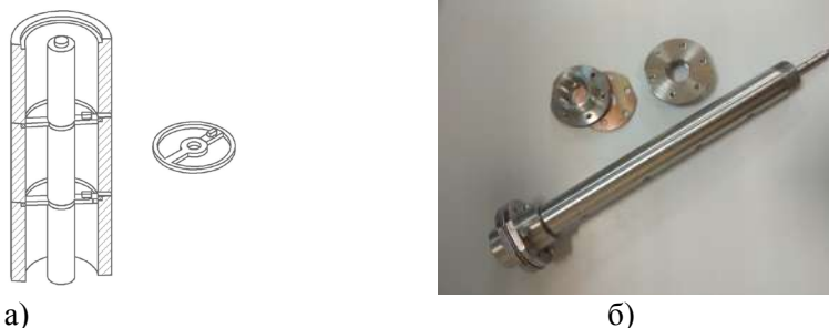
Рис. 2. Вариант исполнения отрезка измерительного зонда в виде коаксиальной линии передачи: а) условное изображение; б) фотография.
