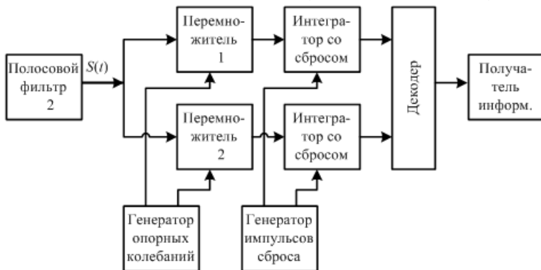
Рис. 2. Структурная схема демодулятора двумерных сигналов
