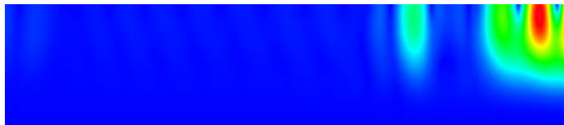
Рис.3 Распределение модуля напряженности электромагнитного поля в продольном сечении волновода
