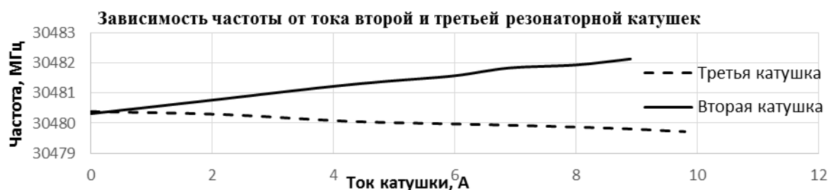
Рис. 2. Зависимость частоты генерации от тока дополнительных катушек
