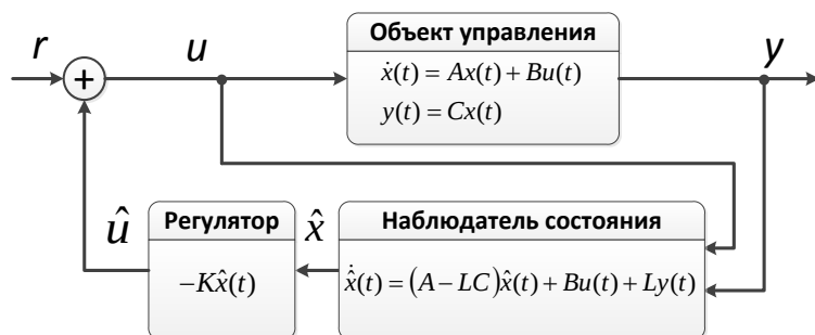
Рисунок 3.2 – Структурная схема оптимальной САУ с наблюдателем состояния
