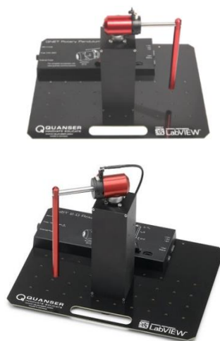
Лабораторный стенд с маятником Фуруты Quanser QNET Rotary Inverted Pendulum 2.0
